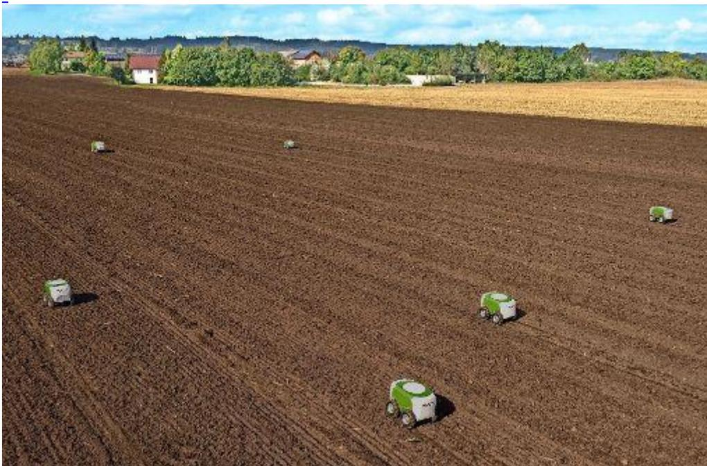
Mit vereinten Kräften: Die kleinen Mars-Roboter arbeiten als Schwarm zusammen und „wissen“ dank GPS genau, wo sie die Samenkörner ablegen müssen. *Foto: Agco Fendt, dpa*
