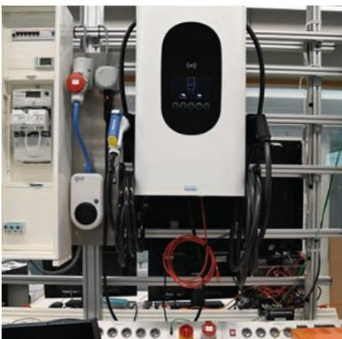
Abbildung 24 | Inbetriebnahme einer bidirektionalen E-Ladesäule.
