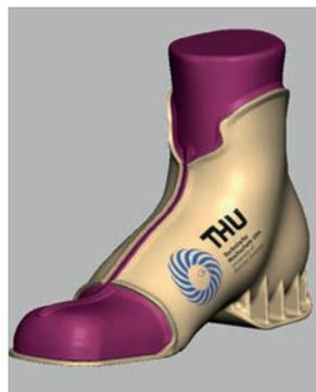
Abbildungen 15/16 | Messung und Digitalisierung eines Fußes (links) und Erstellung des dazugehörigen 3D-Modells (rechts); Quelle: THU
