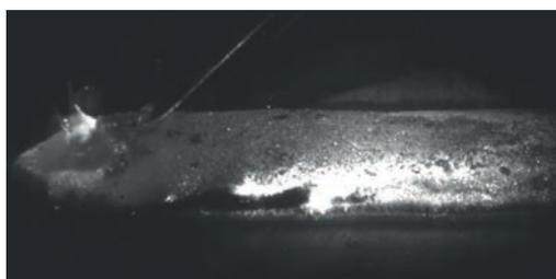
Abbildungen 36/37 | Versuchsaufbau zum Heißdraht unterstützten MSG-Auftragschweißen (links), Hochgeschwindigkeitsaufnahme des Heißdraht unterstützten MSG-Prozesses (rechts); Quelle: THU
