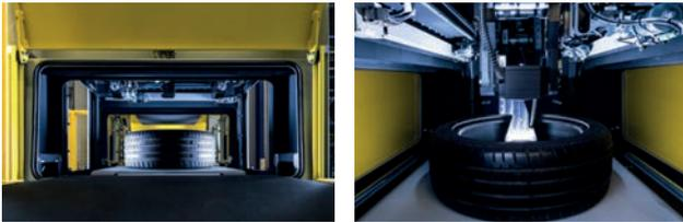
Abbildungen 45/46 | optoelektronische Reifenprüfung
