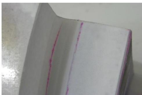
Bruchfläche, Spannung, Anriss PFV; Verlauf der 1. Hauptspannung und Spannungsfälle der Amplitude im Freistich/Leidlich, Lätzer: FKM 294II
