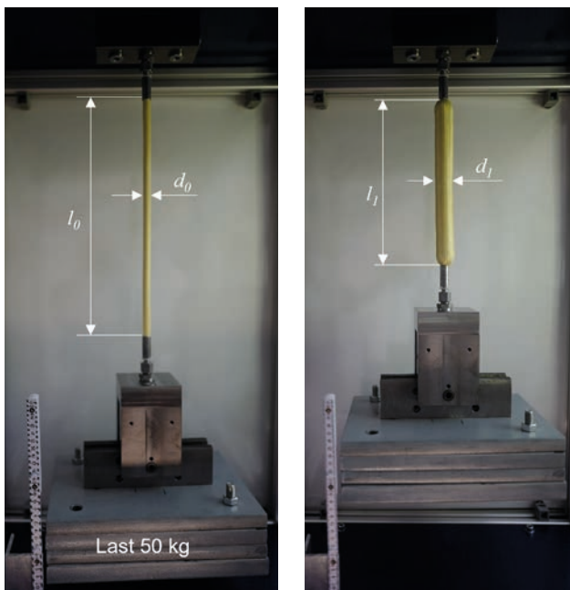
Abbildungen 34/35 | Hydraulischer Muskel: drucklos (links) – unter Druck 5 MPa (rechts); Quelle: THU
