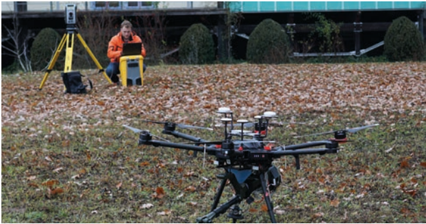
Abbildungen 28/29 | Metalldetektor an einer Drohne zum Aufspüren von Antipersonenminen (links), Bodenmessplatz Find Mine-Projekte (rechts); Quelle: THU
